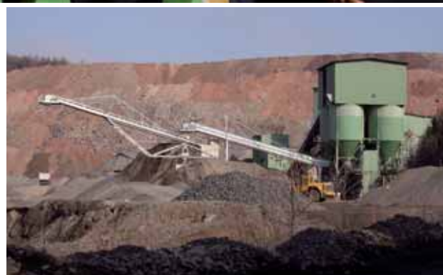
Das neue Förderbandsystem spart Lkw-Fahrten und damit CO 2 -Emissionen.
