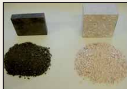
Zuschläge für Schwerbeton: Kupferschlacke, Baryt
